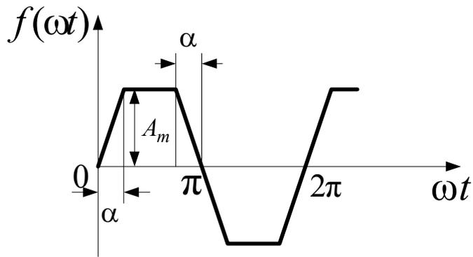
$$f(\omega t) = \frac{4 \cdot A_m}{\alpha \cdot \pi} \left( \sin \alpha \cdot \sin \omega t + \frac{1}{9} \cdot \sin 3\alpha \cdot \sin 3\omega t + \frac{1}{25} \cdot \sin 5\alpha \cdot \sin 5\omega t + \dots \right)$$
