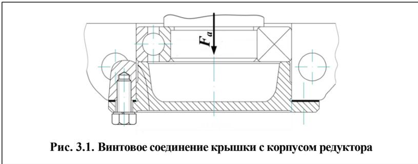
Рис. 3.1. Винтовое соединение крышки с корпусом редуктора
