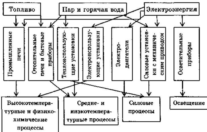
Рис. 6.1. Взаимосвязь энергоресурсов, установок и процессов при выпуске продукции
