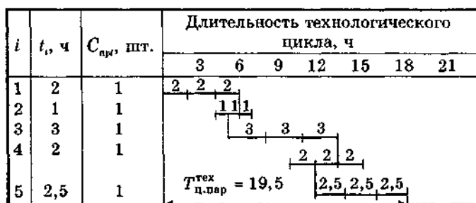
Рис 3.6. График длительности технологического цикла при параллельно-последовательном движении партии деталей в производстве
