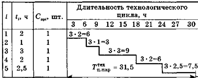
Рис. 3.5. График длительности технологического цикла при последовательном движении партии деталей в производстве
