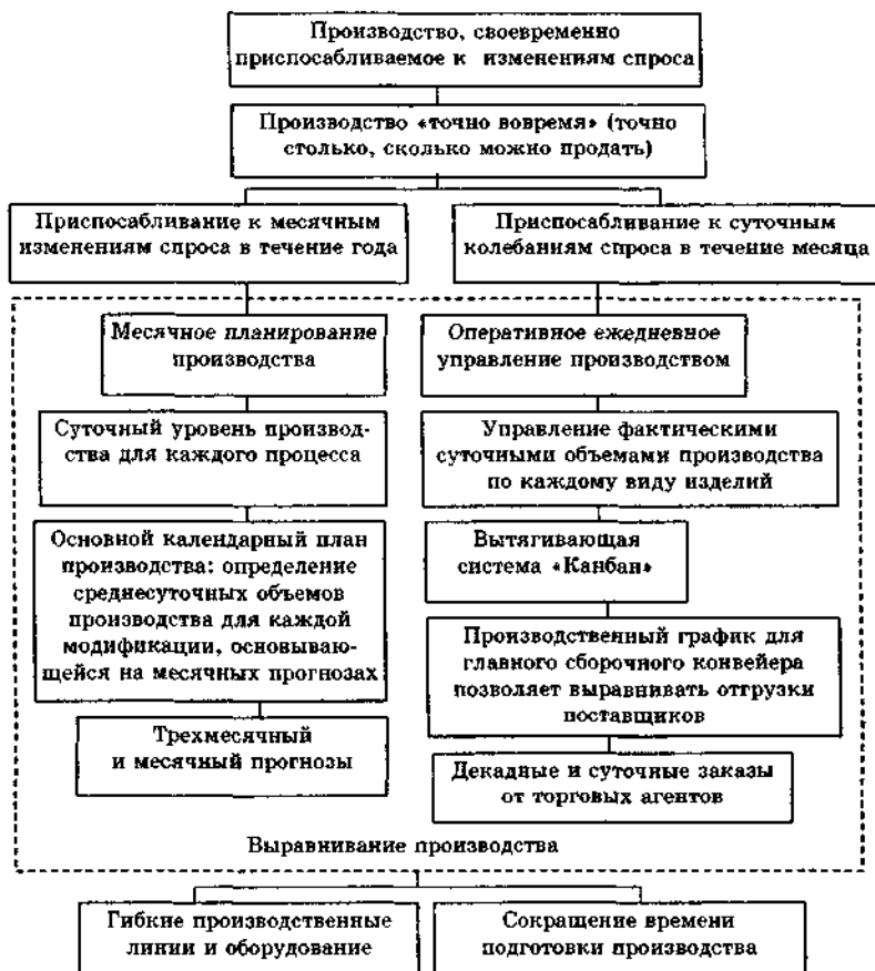
Рис. 7.3. Схема выравнивания производства с изменением спроса на продукцию
