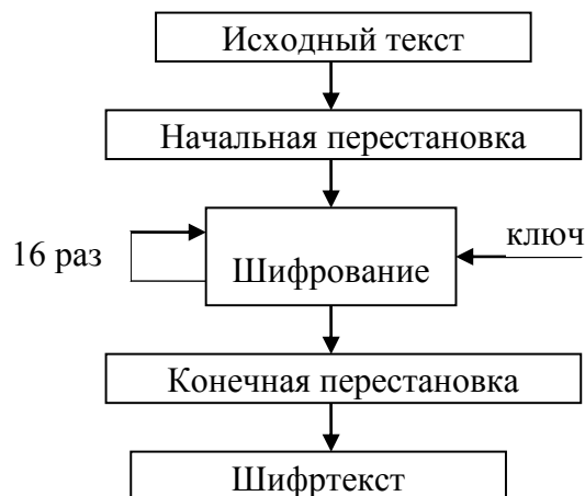
Рисунок 3.2 – Обобщенная схема шифрования в алгоритме DES
