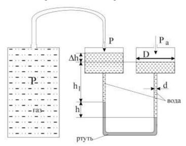
поверхностях воды в чашечках манометра. При этом, пренебрегая изменением давления в столбе газа (ввиду его малой плотности), считая давление P равным давлению газа в баллоне.
