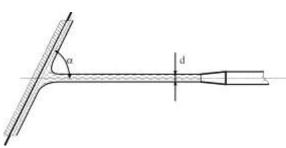
Задача 15. Пожарный брандспойт представляет собой суживающуюся насадку с диаметром выходного сечения d, имеющую коэффициент сопротивления  $\zeta = 0,1$  и коэффициент сжатия  $\varepsilon = 0,85$ . Определить расход воды и силу, с которой
