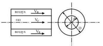
Определить размеры горелки и необходимое давление воздуха, если давление газа перед горелкой  $\Delta P_{\Gamma} \, \kappa \Gamma / \text{m}^2$ , а плотность газа  $\rho_r = 0.98 \, \kappa \Gamma / \text{m}^3$ . Коэффициент скорости и расхода принять равными  $\phi = \mu = 0.82$ , а плотность воздуха при нормальных условиях  $\rho = 1.29 \, \kappa \Gamma / \text{m}^3$ .
