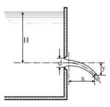
**Задача 17.** Определить коэффициенты расхода, скорости и сопротивления при истечении воды в атмосферу через отверстие диаметром d под напором H, если расход Q, а координаты центра одного из сечений струи x = 3 м и y = 1,2 м.
