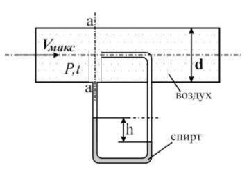
Показание спиртового дифференциального манометра, присоединенного к напорной трубке, равно h. Определить объемный расход воздуха, если избыточное давление воздуха в сечении а–а P ати, температура t  $^{0}$ C, а плотность спирта  $\rho_{cn}$  = 0,8 т/м $^{3}$ .
