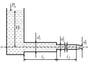
участка имеется задвижка. Определить необходимый напор в баке с учетом потерь местных и на трение при известных коэффициентах сопротивлений:  $\zeta_{\rm BX} = 0.5$ ;  $\zeta_{\rm Hac} = 0.1$ ;  $\zeta_{\rm 3adb} = 2.5$ ;  $\zeta_{\rm BH.cyx.} = 0.5~(1-d_2^{\ 2}/d_1^{\ 2})$ , считая движение установившемся ( $H = {\rm const}$ ). Построить напорную и пьезометрическую линии.
