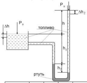
полненный ртутью, плотность которой  $\rho_{\rm pr} = 13,6$  т/м<sup>3</sup>. Определить высоту столба ртути  $h_2$ , если разность уровней топлива в указателе и резервуаре h м. Как изменится положение уровня в указателе при понижении уровня топлива в резервуаре на  $\Delta h$  м?
