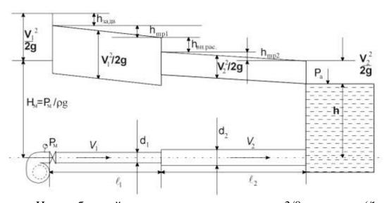
Центробежный насос через прикрытую на 3/8 задвижку ( $\zeta=0.81$ ) и состоящий из двух участков трубопровод ( $d_1=200$  мм,  $\ell_1=10$  м,  $d_2=250$  мм,  $\ell_2=40$  м — загрязненные трубы с эквивалентной шерохо-
